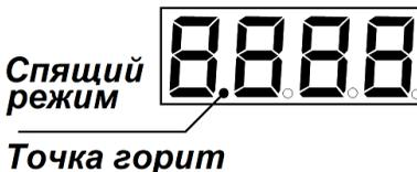
Рисунок 9 – Индикация спящего режима
