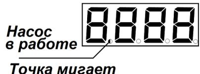
Рисунок 10 – Индикация работы насоса
