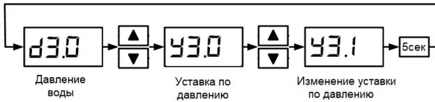
Рисунок 7 – Последовательность изменения уставки давления (P008 = 0)
