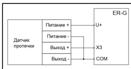
Рисунок 5 – Схема подключение внешнего датчика протечки H2O
