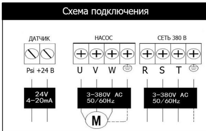
6.3 Подключение поверхностного насоса к прибору производится в его клеммной коробке или через розетку с заземляющим контактом.
